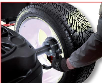
**IT** Nuovo sistema di acquisizione dei dati ruota tramite accelerometro.
